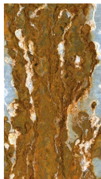
Galvanizado a Quente 20µm após 6 semanas
